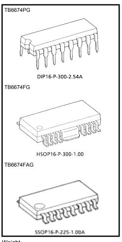
Weight DIP16-P-300-2.54A: 1.11 g (typ.) HSOP16-P-300-1.00: 0.50 g (typ.) SSOP16-P-225-1.00A: 0.14 g (typ.)
